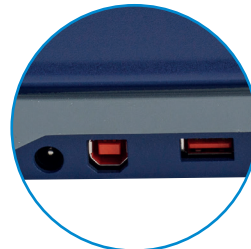
D USB 2.0-Anschluss zum Aufladen eines Smartphones, USB-Kabel und USB-Anschlüsse 2.0 Typen A & B
