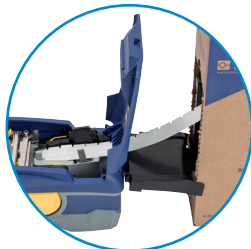
B Einfaches Einsetzen des Materials, optional für Großpackungen geeignet
