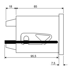
Schalttafel-Einbau mit Befestigungs-Spangen
