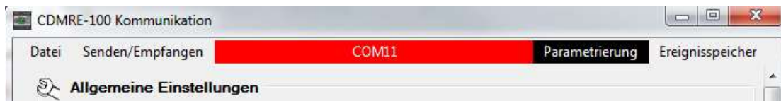
Abb. 11 - CDMRE-100 Kommunikation - Falscher COM Port
